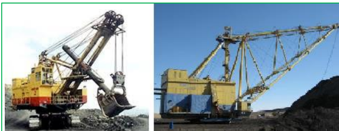
Зураг 2.6 ЭКГ-5А экскаватор болон ЭШ-25/90 алхагч экскаватор
